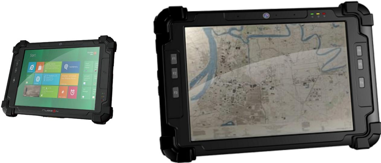
**La Tablet PC DR10** est une tablette tactile durcie (\*), multimédia sous windows 7 et 10 pro 64 Bits. Elle est robuste avec une conception conçue pour satisfaire les normes MIL-STD810G (hautes et basses températures, chocs, vibrations, chutes de 1,5m), résistante à l'eau et la poussière IP65, sans ventilateur, lisible au soleil.
