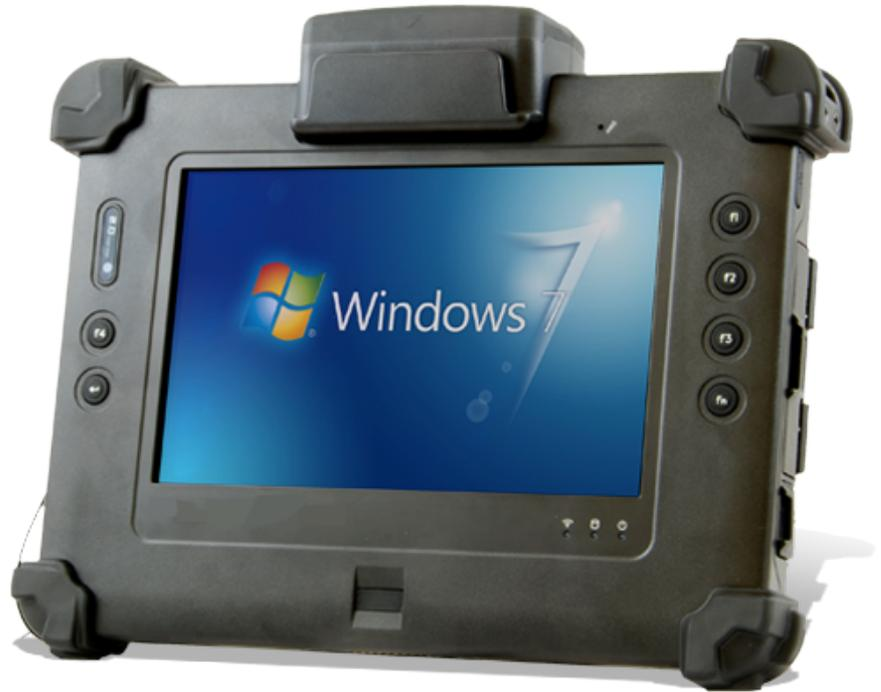
**La Tablet PC DR7B** est une tablette tactile durcie (\*), multimédia sous windows 7 et 10 64 Bits. Elle est robuste avec une conception conçue pour satisfaire les normes MIL-STD810G (hautes et basses températures, chocs, vibrations, chutes de 1,5m), résistante à l'eau et la poussière IP65, sans ventilateur, lisible au soleil.
